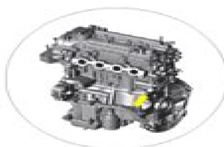
Engine Number (Kappa 1.2 / 1.4 MPI Gasoline)
