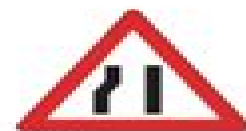
W330 Barabara nyembamba kutoka upande wa kushoto
